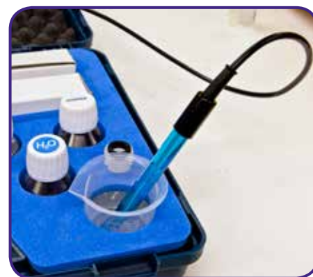
Campione in misura alloggiato nella valigia per evitare accidentali ribaltamenti
